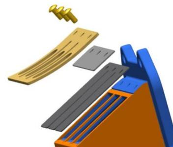
**5.3.3.** Os dois espaçadores têm a gravação "ROTAX", conforme o seguinte esquema. Cada espaçador tem de ser plano, sem curvatura, e cumprir com as especificações abaixo. A referência ROTAX pode estar gravada no espaçador.
