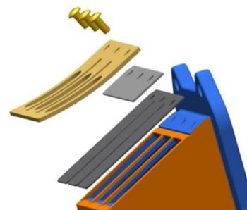
4.5.3. Os dois espaçadores têm a gravação “ROTAX”, conforme o seguinte esquema. Cada espaçador tem de ser plano, sem curvatura, e cumprir com as especificações abaixo. A referência ROTAX pode estar gravada no espaçador.
