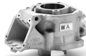
**6.3.2.** Diâmetro máximo do cilindro = 54,035 mm (medido 10 mm acima da janela de escape).
