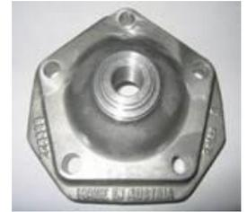
c) A altura da câmara de combustão (H) é de 28,80 mm com uma tolerância de +/- 0,2 mm.
