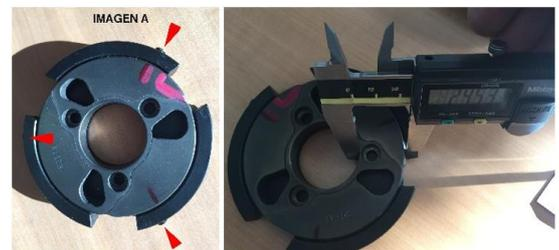
A ferramenta da imagem A permite fechar completamente a embraiagem com a ajuda dos 3 parafusos (assinalados na imagem com as setas vermelhas).
