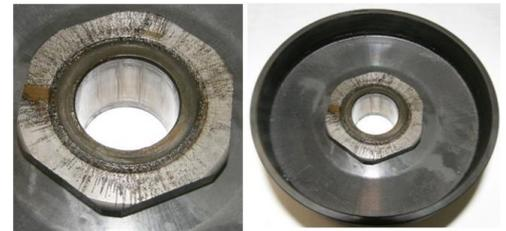
As imagens mostram a situação extrema de existência de substância lubrificante na campânula, mesmo que a massa lubrificante passe a área do rolamento com o «o-ring» instalado.
